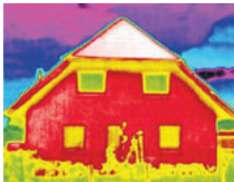
So könnte eine Wärmebild-Aufnahme aussehen: An den hellen Partien geht Wärme verloren, die dunklen sind gut isoliert. FOTO: FR
